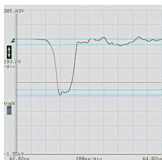
図2: 高速パルサーからの高電圧パルス出力波形。パルス幅約250 ps、振幅約750 V。
