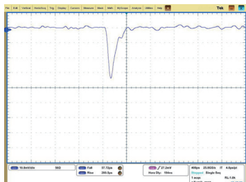
図4: ミリ波検波器で受けたシングルバンチからのCTR波形。
