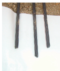
写真5：切断後PC鋼より線
