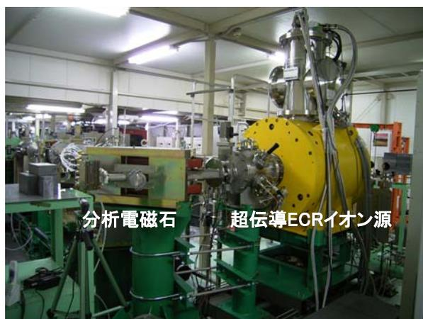
図2：18GHz超伝導ECRイオン源と分析電磁石
