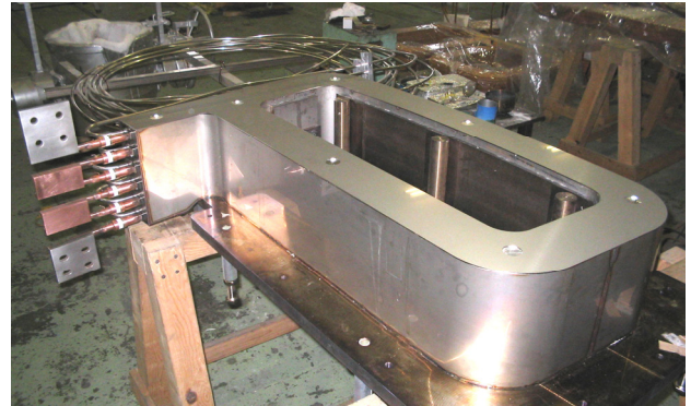
図4：実機電磁石用間接水冷型MICコイル
