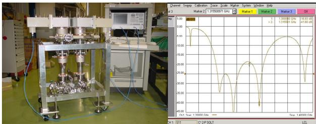
図7：入力結合器の大電力試験装置組み立て時における周波数特性の測定、(S11=-18.8 dB at 1.3 GHz)
