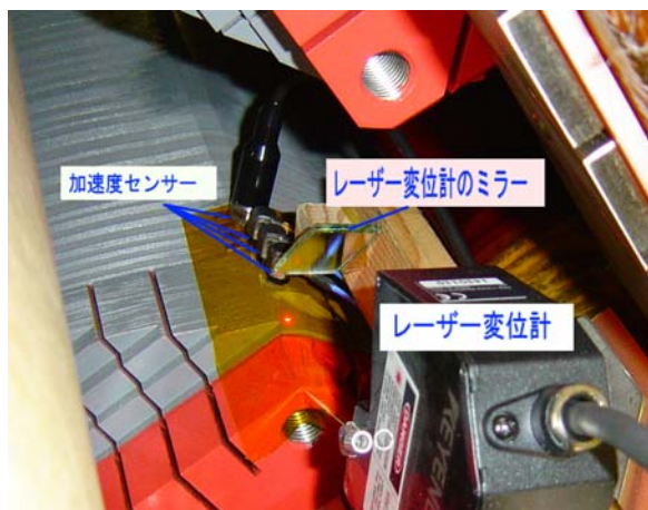
写真1 四極電磁石による変位計テスト
