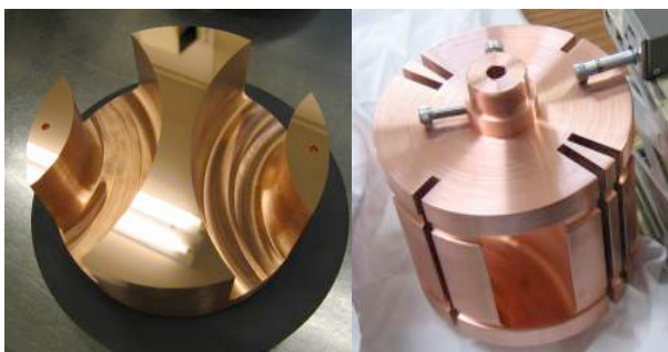
図2：導波管切替器ローター部（左：拡散接合前、右：電解研磨前）
