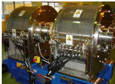
図2: 加速空洞の外観
