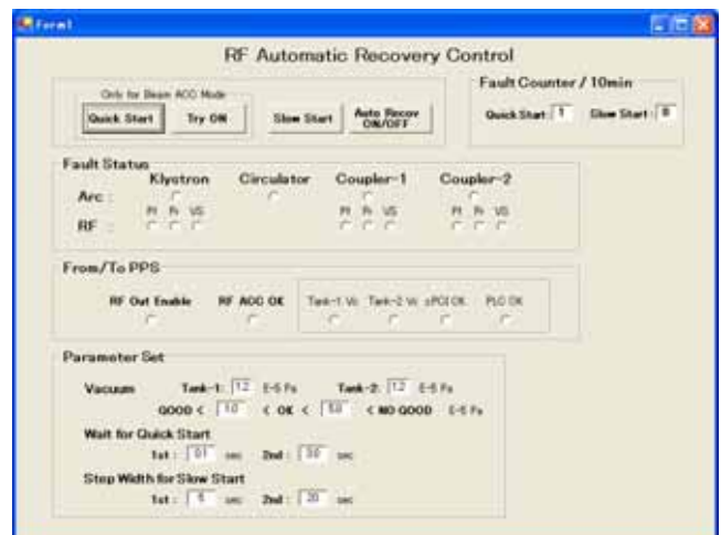
図3 自動復帰の操作画面 (タッチパネルイメージ図)
