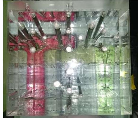
図2. 評価用ファントム（アクリル＋鉄筋6～10 mm径混在）
