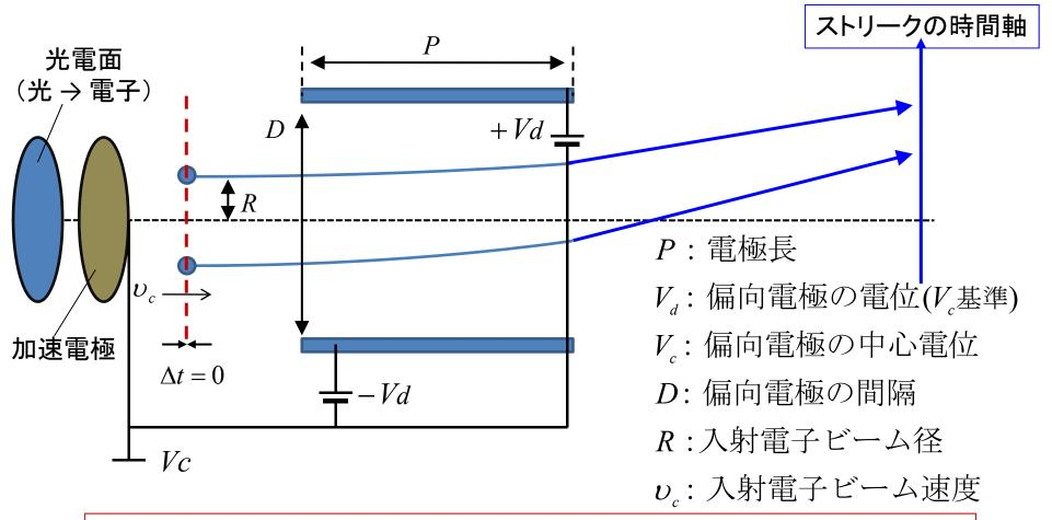
偏向電界による電子の走行拡がりが、エネルギー分散によってさらに大きくなる
