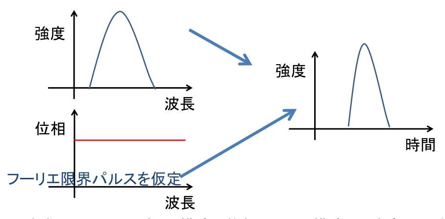
・実際のLINACのバンチ構造は複雑で、その構造で最も高い周波数成分をみているだけ(電子がその成分に大多数いるのかが重要)
