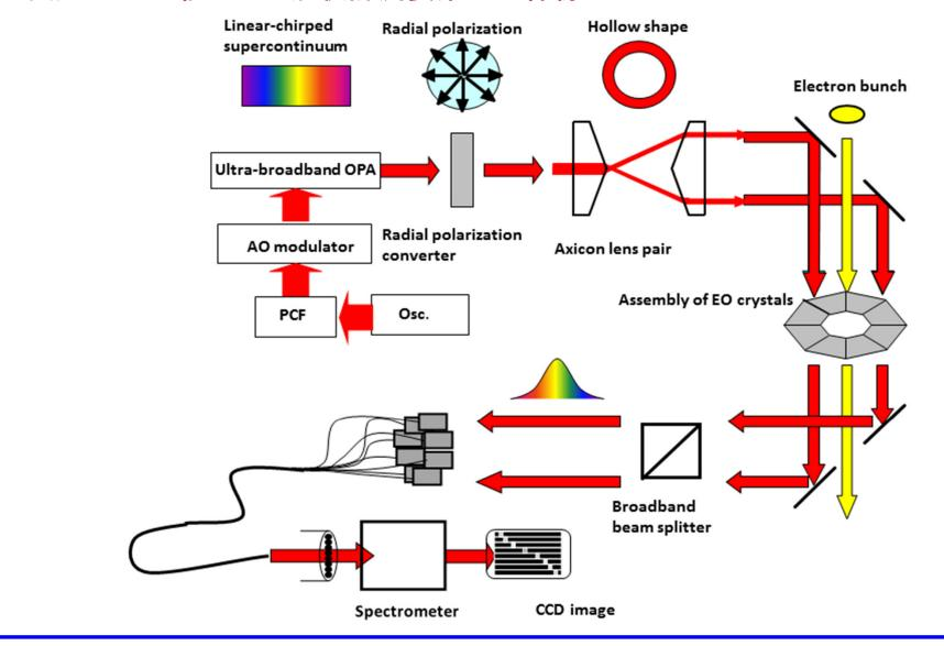
データ収集系の基本戦略は、3D/6D電子バンチ計測のリアルタイム再構築系の基本コンポーネントである、空間多重化と融合した技術で構成する(<u>多重化密度の極大化</u>)。
