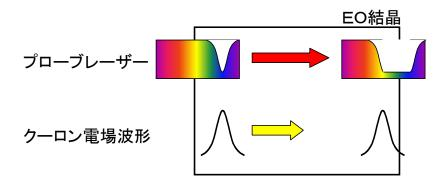
フェムト秒時間分解能のためには、 白色レーザーパルス(バンド幅 > 300nm)と有機結晶が必要。
