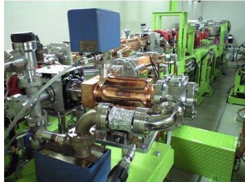
図4 : FIR-FELにインストールされた電子銃
