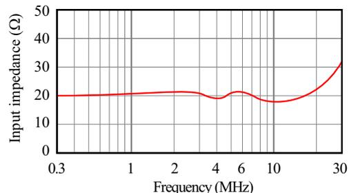
図4：入力インピーダンス測定結果。
