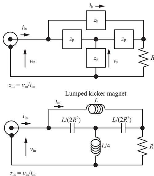
図1: T架橋型四端子回路網 (上) と、 $z_k$  をインダクタンス  $L$  のキッカー電磁石とした場合 (下)。
