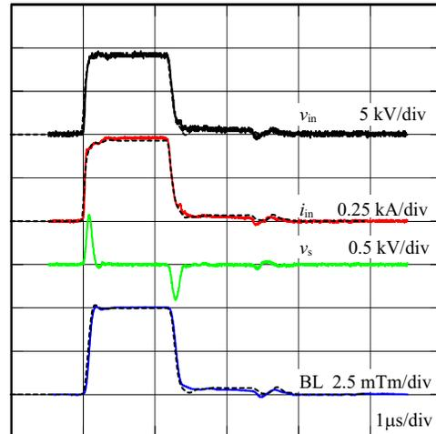
図3：パルス応答試験の結果。上から入力電圧、入力電流、サーチコイル出力電圧、および、積分磁場。点線は計算値。
