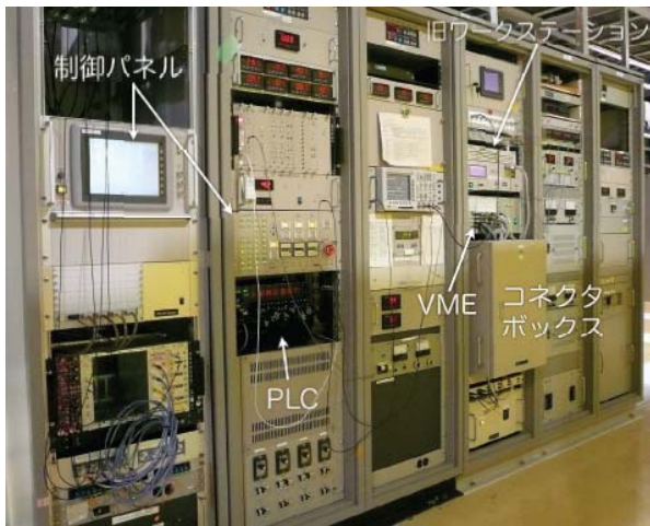
図2. Linacクライストロン変調器制御系 (旧ワークステーション部がArmadillo-220での制御に置き換わった)
