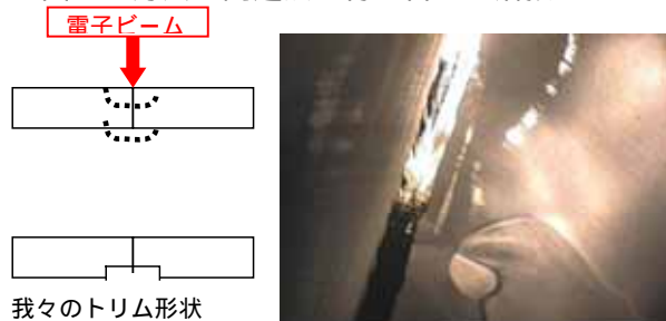
図2：赤道部のトリム加工とEBWシーム状態
