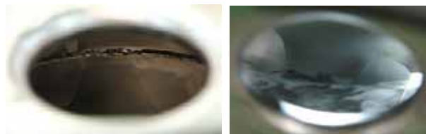
図3：ダンベル組立途中で発生した溶接不具合（左）とグラインドによる修正（右）
