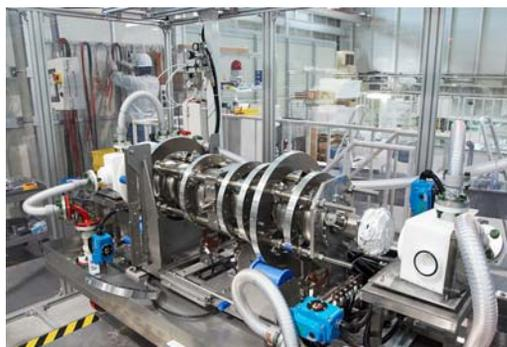
図 1: ILC/STF 超伝導空洞用電解研磨装置
