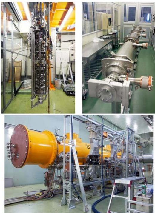
図 3: ILC/STF 超伝導空洞 (左上)縦測定準備段階 (右上)連結された 4 空洞 (下)横型クライオスタット
