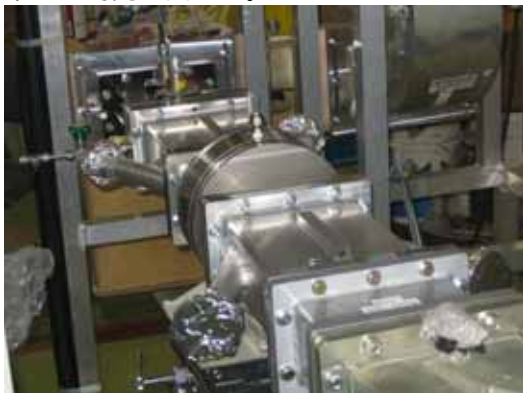
図：5 高周波窓の透過電力試験
