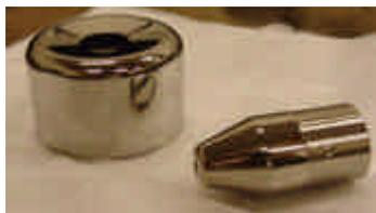
図3：カソード・アノード電極 (研磨後)
