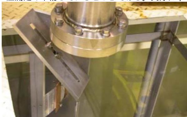
ように測定したい水圧を確認した後に、銅版の鏡面側に高圧超純水を当てて洗浄した。その前後に各サンプル面の表面状態を光学顕微鏡とFTIR装置で測定した。洗浄サンプル片は、洗浄後すぐに真空デシケータ（0.09MPaまで真空引きした）で測定までの数日間保管した。
