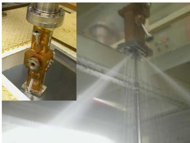
図2：RF電子銃空洞の洗浄試験
