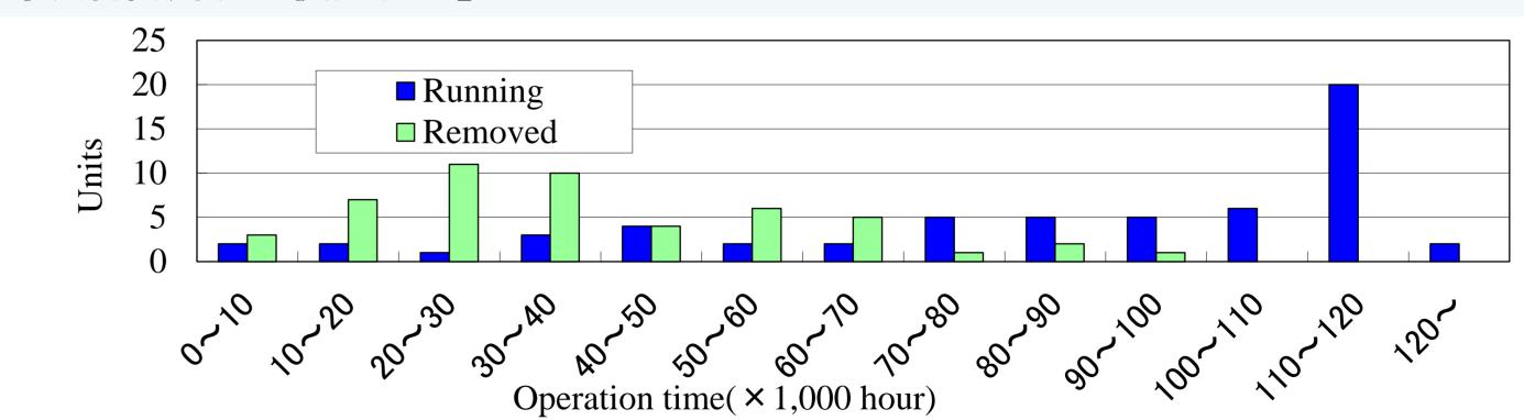
現在使用中の導波管高周波窓は11~12万時間使用しているものが最も多く、平均運転時間は約84,000時間である。撤去済み導波管高周波窓の平均運転時間は約59,000時間である。
