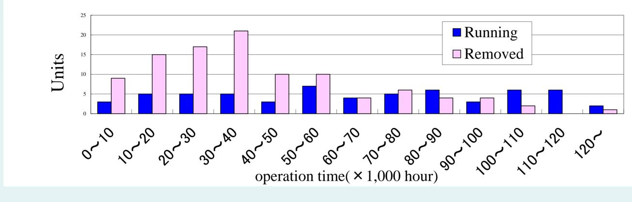
現在使用しているクライストロンの平均運転時間は約65,000時間であり、不具合により撤去したクライストロンアセンブリの平均運転時間は約39,000時間である。
