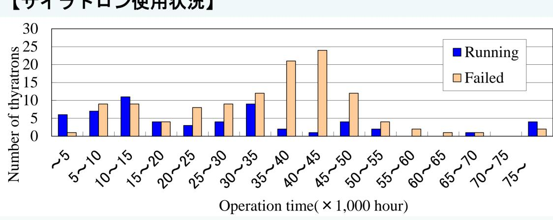
2019年3月現在運転しているサイラトロンの平均運転時間は約34,000時間である。また、故障により交換したものの平均運転時間は約38,000時間である。
