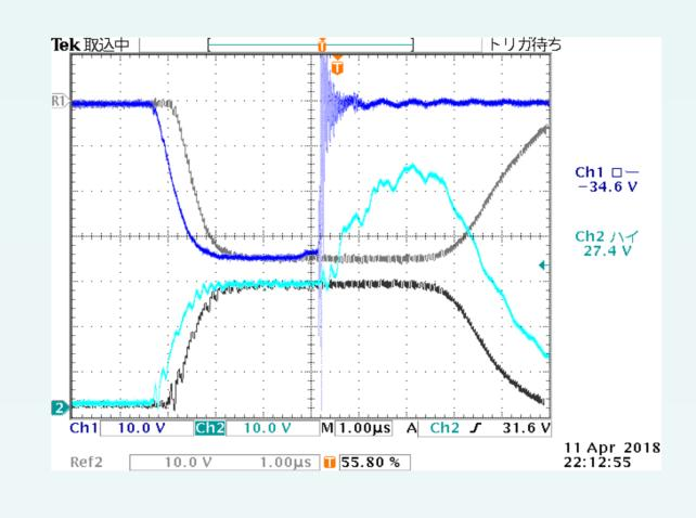
ダウン時の**クライストロン電流波形に放電(電流が大きく増加)の履歴**が見られた。
