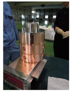
カンタルの溶射範囲は空洞の Q 値が 1300 (レギュラーセルは 20000) になるように CST を用いて決定。アイリス径、シリンダー径は反射が定常状態で -20 dB 以下、マッチングセルとロードセルのフィールドバランスが進行波型の最後のレギュラーセルと最初のロードセルと同じになるように決めた。
