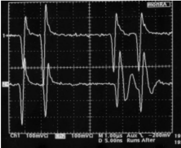
図1：オシロスコープにより観測したBPM出力信号波形の異常。右下の2波形が異常となっている。
