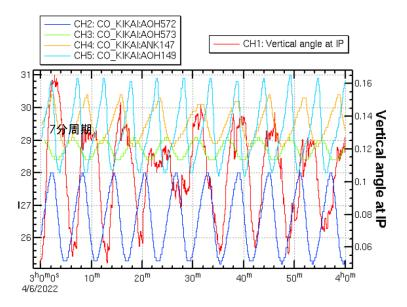
AOH572: マグネットTN内純水冷却水往温度(大穂3M機械棟) AOH573: マグネットTN内純水冷却水環温度(大穂3M機械棟) ANK147: 日光冷却マグネット往温度 AOH149: 大穂冷却マグネット往温度
